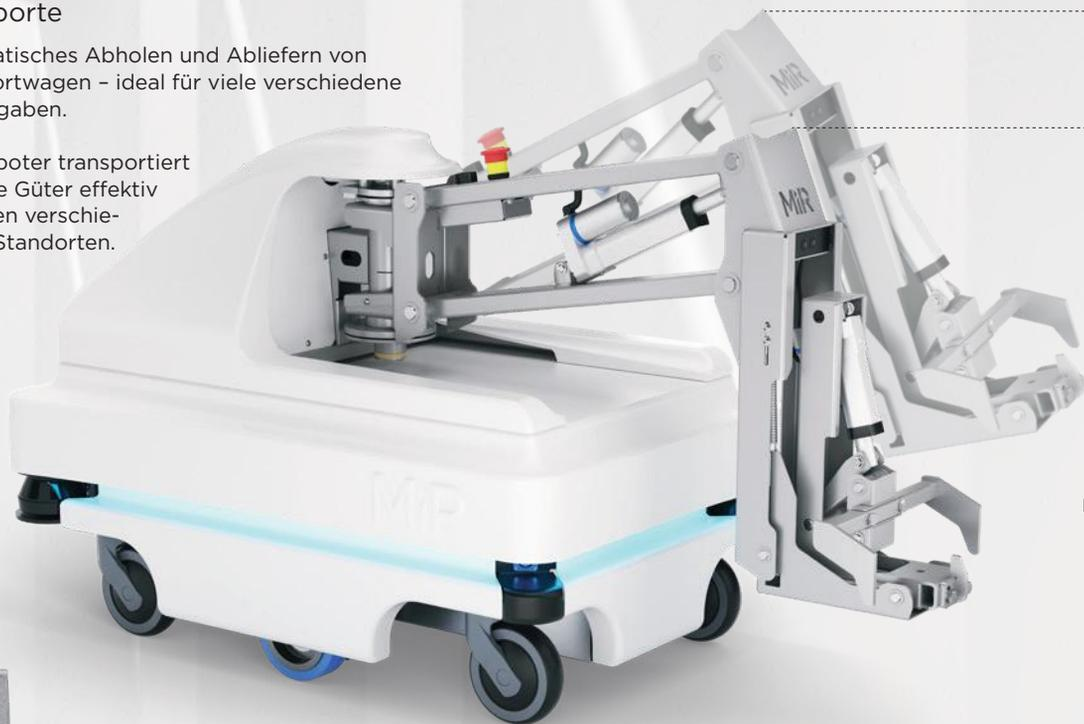
Höchste Position über dem Boden: 1180 mm
