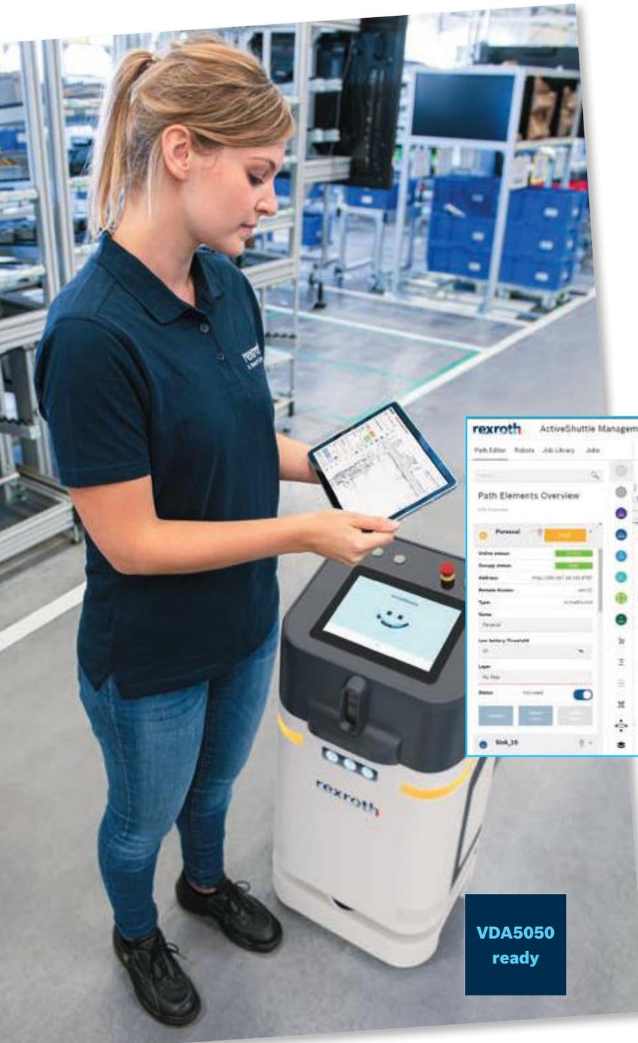
Das ActiveShuttle Management System (AMS) ist das Herzstück des Gesamtsystems und übernimmt die zentrale Steuerung der kompletten ActiveShuttle-Flotte. Als Steuerungssoftware stellt das AMS den Live-Zustand Ihrer Flotte dar, weist verfügbaren Fahrzeugen anstehende Transportaufträge zu und dient dem Nutzer zur Steuerung und flexiblen Konfiguration der Logistikszenerien während des Produktivbetriebs.
